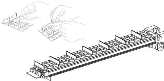
Das patentierte Ausgabesystem ist variabel einsetzbar. Als Förderband schiebt es die Produkte sicher nach vorne auf den Lift. Es lassen sich mehrere Bänder zu einer Produktausgabe kombinieren, bequem per Klick ohne Umbauarbeiten.
